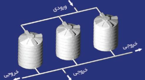
۳ در مواقعي که نیاز است مخازن روزانه پر و خالی شوند، استفاده از مخازن عمودی به جای مخازن افقی توصیه می‌گردد.
