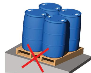
۲ نمونه‌ای از پالت مورد تایید جهت انبارش و یا جایه‌جایی بشکه‌ها در شکل زیرنشان داده شده است. جنس و طراحی پالت‌ها باید به گونه‌ای باشد تا در برابر نیروی وزن بشکه‌ها مقاومت کند و دچار تغییر شکل نشود. همچنین سطح فوقانی و زیرین پالت‌ها باید کاملاً سالم، صاف و بدون عیب باشند. شکستگی پالت‌ها یا وجود هرگونه اشیای تیز و برخنده می‌تواند موجب آسیب دیدگی جدی بشکه‌ها شود (تمامی ابعاد به میلی متر است).
